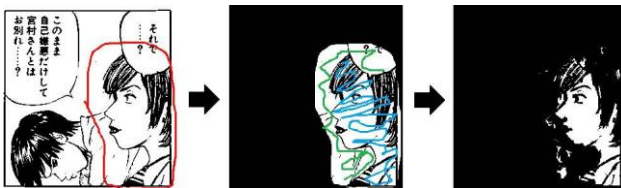
図4 セグメンテーション (左:入力, 中央:内部領域 (青) と外部領域 (緑) をユーザーが指定, 右:結果)
