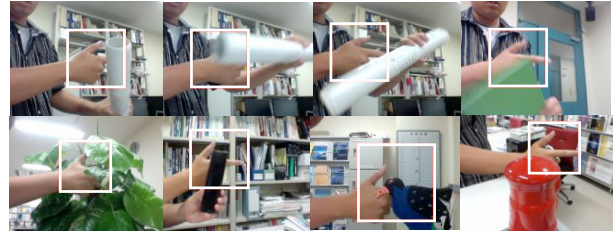
図4: 手検出実験成功例. 画像内で手らしさ s の値が最も高い領域を枠で囲った。
