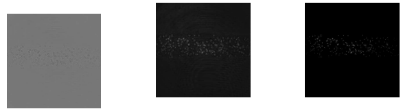
図 4: ホログラム 図 5: ソフトウェアによる再生像 図 6: ハードウェアによる再生像
