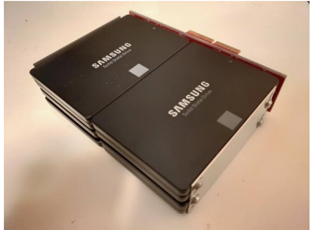
図 2 SSD 拡張モジュールに SAMSUNG EVO 860 SSD を 8 台同時に接続した図
