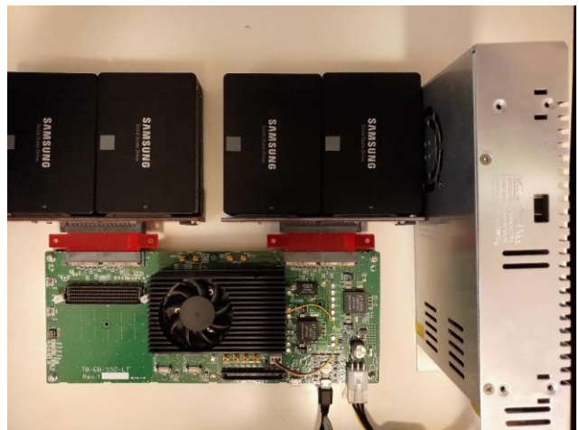
図 3 SATA サブ基板 1 台に対し、最大接続可能台数である 16 台の SSD を接続した図
