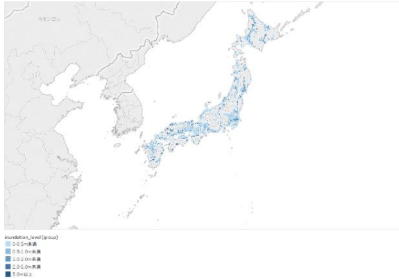
図 5 平成 24 年度国土交通省水深想定区域浸水深 3 次メッシュデータの可視化図。色の濃淡が浸水深レベルに対応する。
