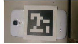
図 8: 背面に AR マーカを取り付けたスマートフォン
