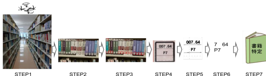
図1 ドローンを用いた書籍照合の処理の流れ
