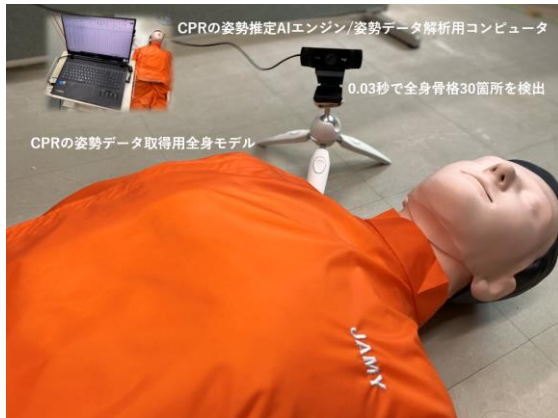
図 9 CPR 姿勢の kinetic chain を解明する実験装置
