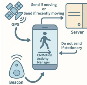
図4: モーションセンサを用いた測位システムの構成
