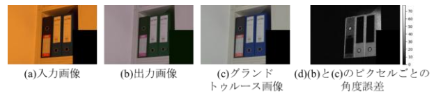
図 3 提案手法で光源色の影響を低減した結果
