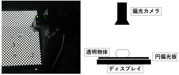
図1: 計測システム画像と模式図. ディスプレイに表示した背景パターンを円偏光板で円偏光化し、透過した光を偏光カメラで撮像する.
