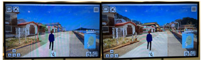
図 4 点群サイズ調整 (左が一定サイズ、右が距離に応じた可変サイズ)
