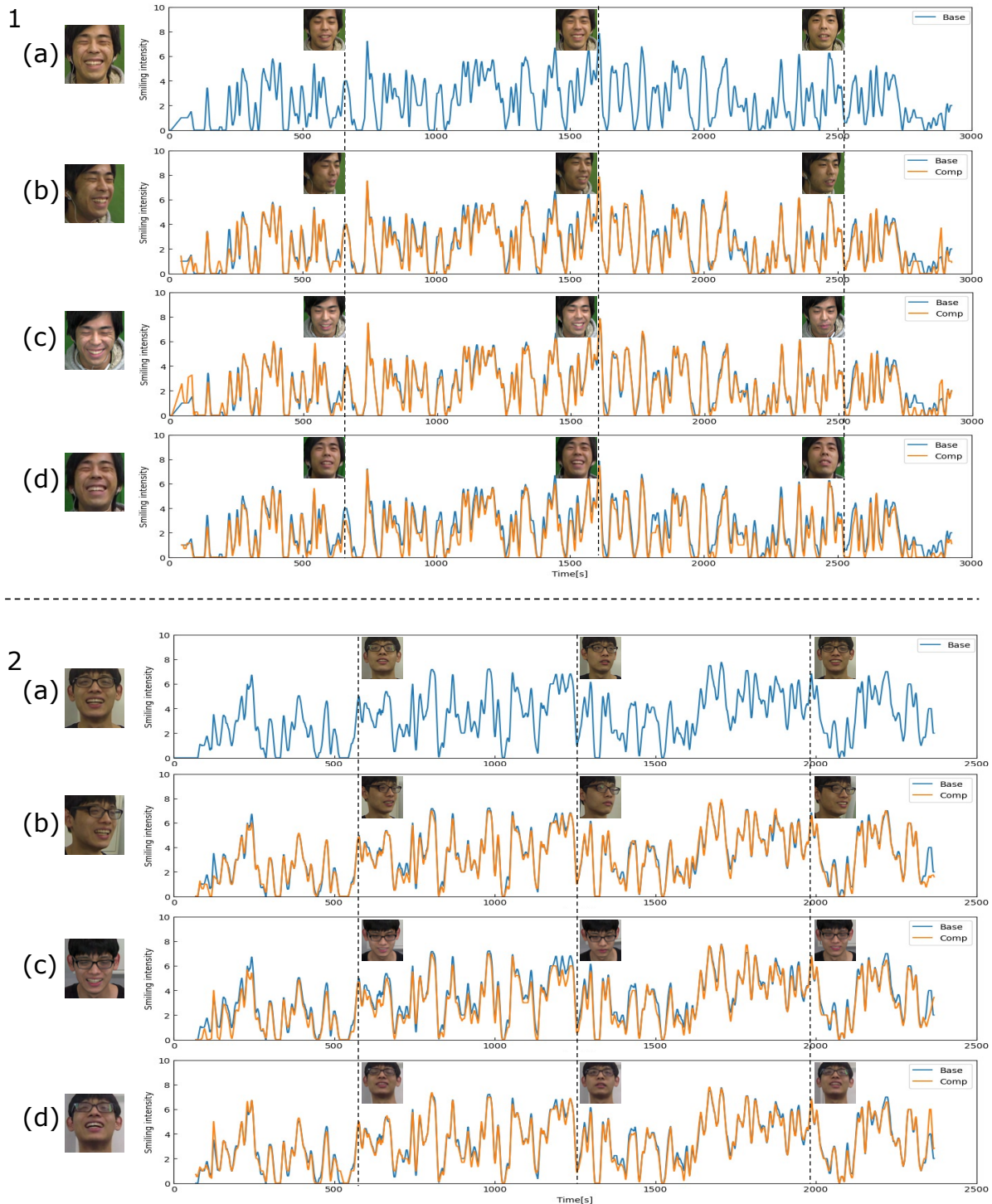
図9 各顔向き (a) 正面 (b) 斜め (c) 下 (d) 上に対する笑顔度推定結果 (それぞれの顔向きについては独立に推定を行ったもの)。青線は正面顔の強度変化, 橙線は各顔向きの強度変化を表す。上段は実験協力者1。下段は実験協力者2。
