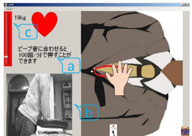
図 3 CPR の実技シーン ; (a)胸骨圧迫の動的キャプション表示 (b)胸骨圧迫の姿勢表示 (c)圧迫荷重表示
