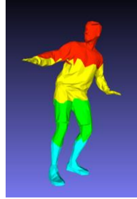
図 1 V-DMC のサブメッシュ生成例
