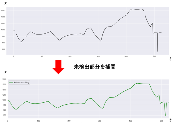
図4 カルマンフィルタを用いた座標補間の結果(x座標)
