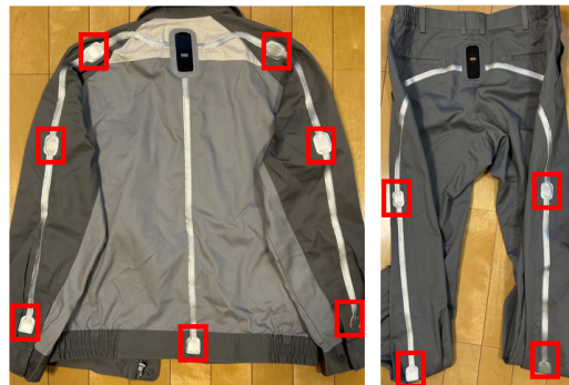
図 1: 衣服型センシングデバイス (各矩形位置に IMU センサが縫い付けられている)
