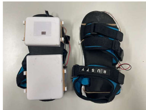
図 1 開発した靴型 VR デバイス
