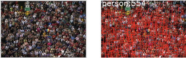
図 5: Yolov8x を用いた検出ベースの人数カウント 左: 元画像 右: 検出結果
