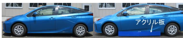
(a) 正常状態の車両 (b) 異常状態の車両 図 2 3 次元形状を計測した車両の概要
