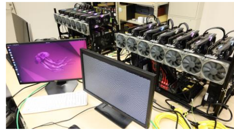
図 3 12 枚の GPU を搭載した CGH 計算ノード
