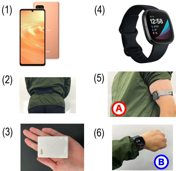
図 2 計測に使ったデバイス。(1) スマートフォン (SHARP AQUOS sense 6), (2)(1) をベルトポーチで腰に装着した様子, (3)BLE ビーコン (アプリックス製 MyBeacon®), 屋内に 97 箇所設置, (4) スマートウォッチ (fitbit sense), 絵文字回答アプリを実装。装着方法には (5) と (6) の方法があるが, 食品衛生法に関わる禁止事項を避けるため, 調理現場では (5), それ以外は (6) の装着方法で運用。
