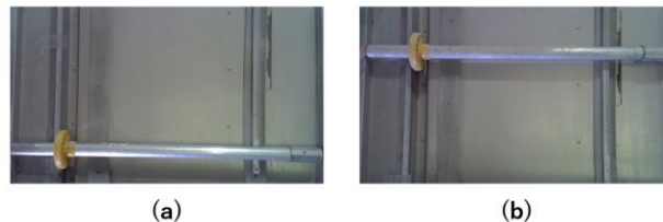
図 2 学習・推論に使用する建設機材画像 (a):正常, (b):異常(汚れ)
