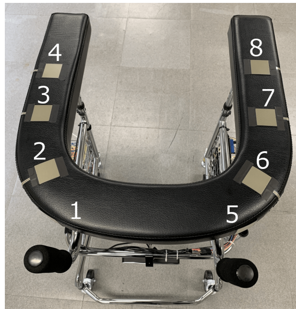
図3 ロボット歩行器の前腕支持部に搭載した圧力センサ (数字は圧力センサの番号)
