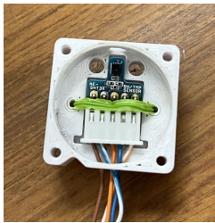
図 8 強制通風筒内部
