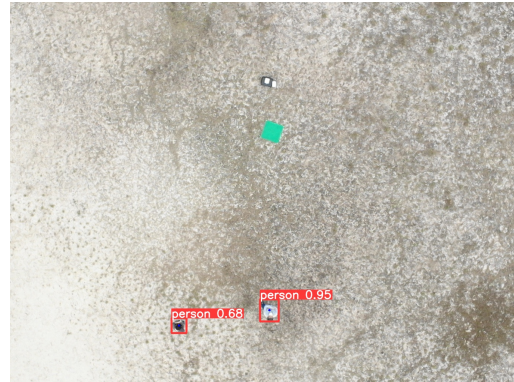
図 5 開発したシステムの検出結果 (yolov5m6)
