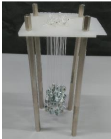
図 5 指向性ポリウムディスプレイ
