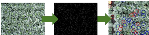
図 2 Hough 変換, HSV 色空間情報による検出
