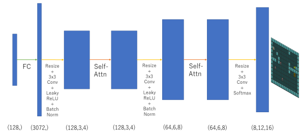
図 3 Generator の概略図
