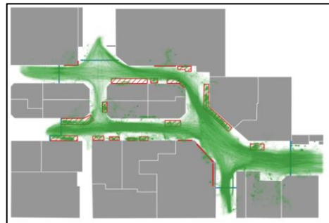
図 2 某ショッピングモールにて取得した人流計測データの例(緑線)。
