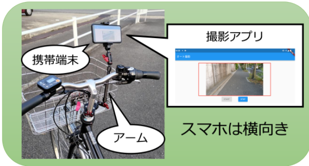
図 3: 自転車へのスマホの取り付けと撮影アプリ画面
