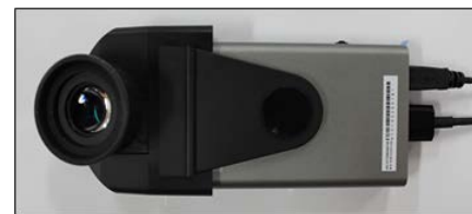
図2. レーザ網膜投影機器
