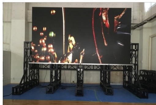
図 1. 実験に用いた 200 インチ LED ディスプレイ
