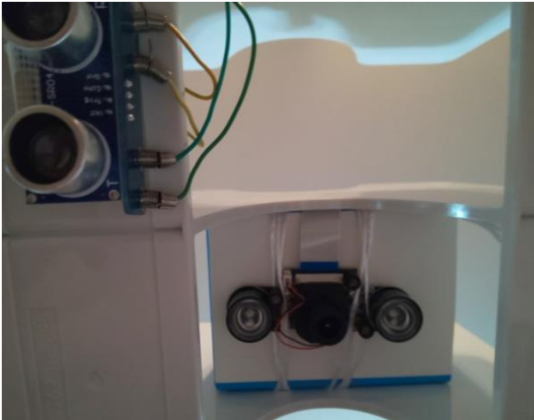
図7 赤外線カメラを用いた ゴミ画像分類ポータブルツール下部
