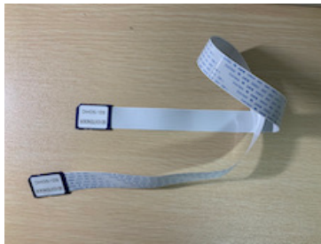
図11 SD エクステンションケーブルの画像。両端がSDカードの形状をしているフラットケーブルである。
