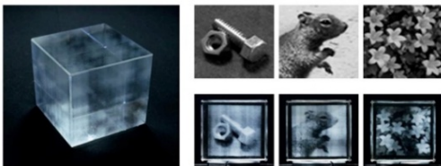
図1 3Dクリスタルを用いた指向性ボリュームディスプレイ
