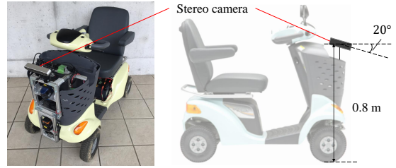
図 3 実験車両とセンサの取り付け位置
