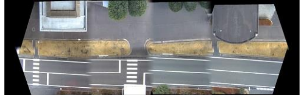
図 1 カメラ位置姿勢変化によるずれ発生時の俯瞰合成画像
