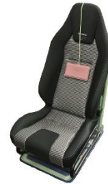
図1 自動車用シートに装着した呼吸・心拍計
