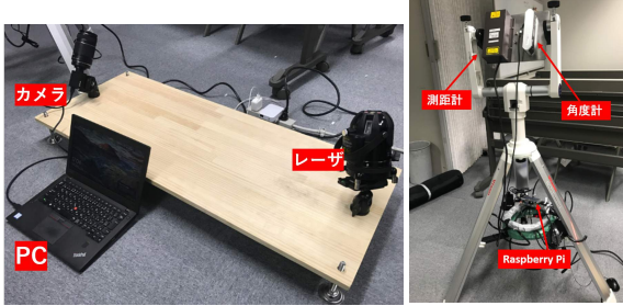
図3 光切断法システムの構成図 図4 位相差測距システムの構成図
