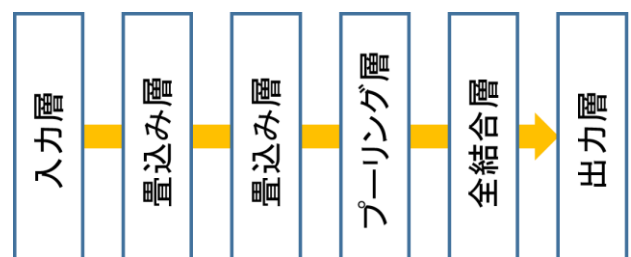
図 2 正規化ラベルのネットワーク構造
