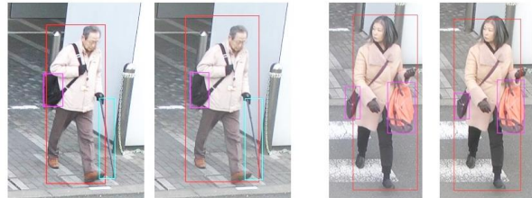
図 3 完全手動と提案手法とのラベル位置ずれ例 (左: 完全手動, 右: 提案手法)
