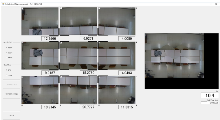
図2 俯瞰画像合成システム (川崎医療福祉大学 8015 演習室)
