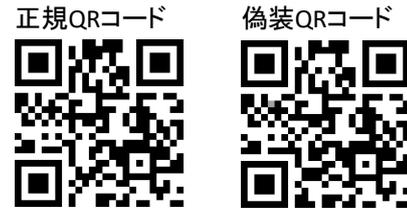
図11 モジュールの輝度値を変化させて作成した偽装QRコード
