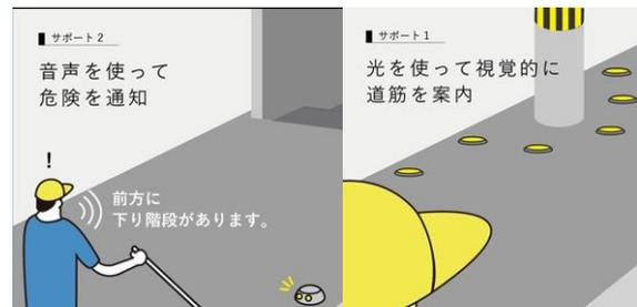
図 1 自発光式道路鋏を用いた歩道支援システム
