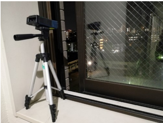
図 9 レーザ距離計を設置している様子
