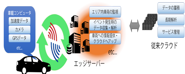
図1 冬道凹凸検出アプリケーションのエッジコンピューティングによる実現例[5]
