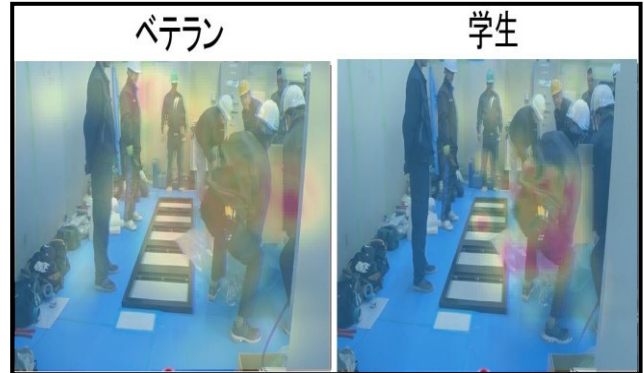
図17 動画3におけるヒートマップ (電子制御盤取り出し作業)
