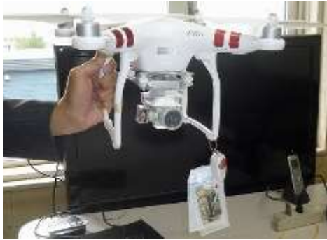
図 4 マルチコプターに装着した威嚇音発生装置
