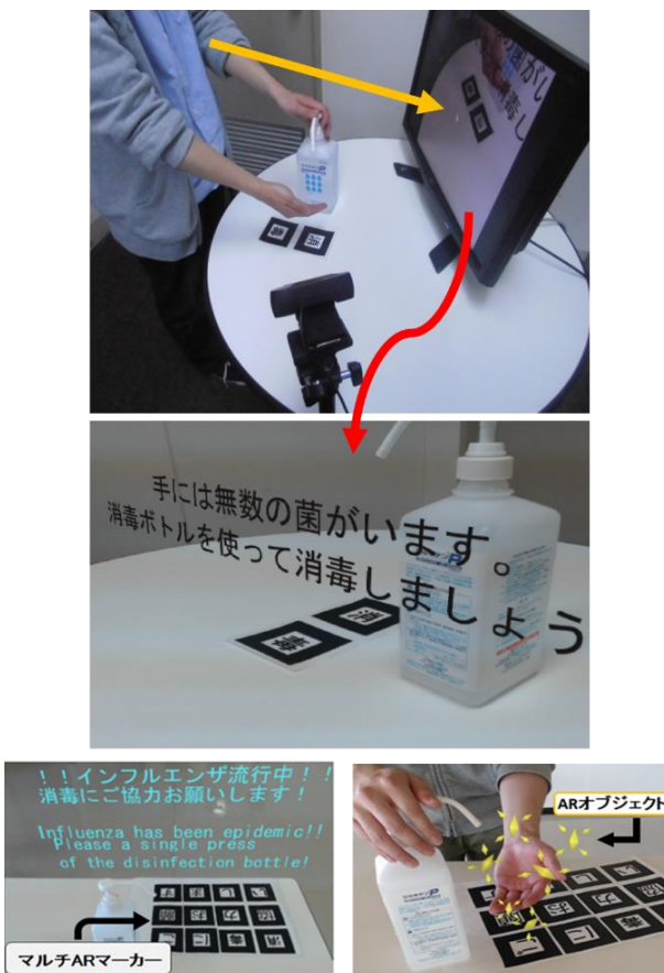
図4 システム構成の概要とコンテンツの画面遷移
